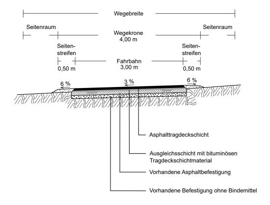
Regelquerschnitt für Wirtschaftswege in regionaler Bauweise Sonderbauweise Deckenverstärkung einer Asphaltbefestigung
