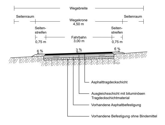
Regelquerschnitt für Holzabfuhrwege in regionaler Bauweise Standardbauweise nach RLW 2005, Bild 8.3a, Zeile 2
